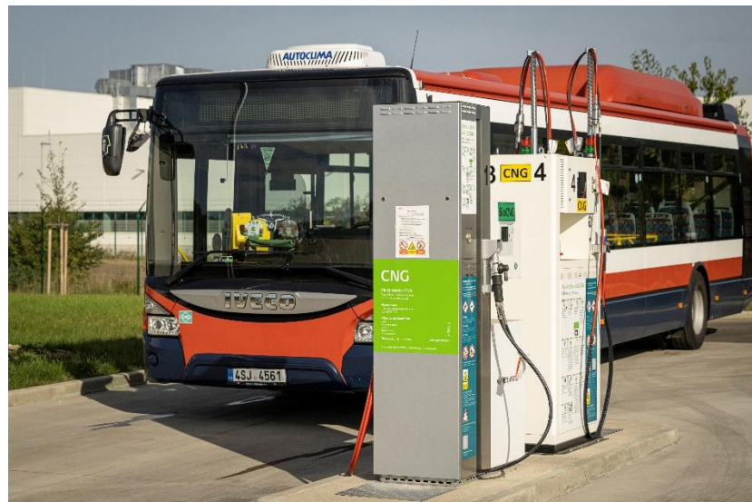
FOTOGRAFIE: Čerpání PHM v areálu bioplynové stanice.
